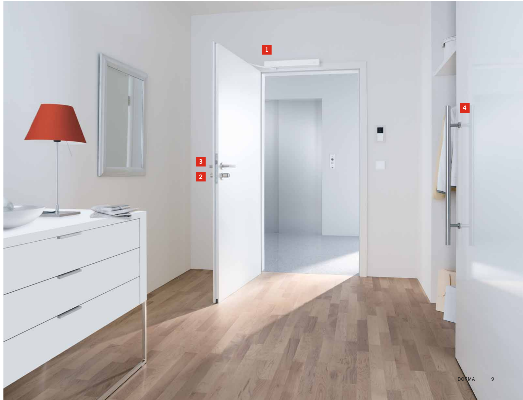
1 Der Türassistent PORTEO öffnet und schließt die Eingangstür zur Wohnung automatisch und sicher. Auf Wunsch mit Funkhandtaster.
